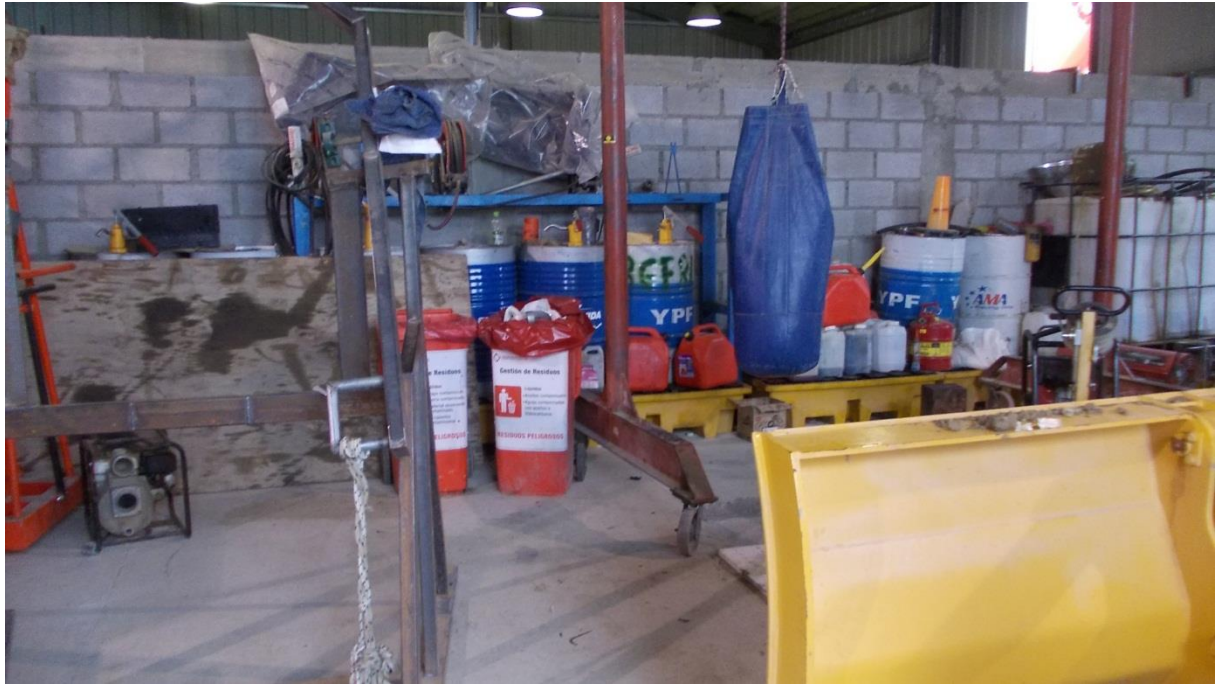
Figura 39. Tachos de acopio de residuos peligrosos en taller de mantenimiento. Acopio de combustibles y lubricantes sobre contenciones secundarias en taller de mantenimiento.
