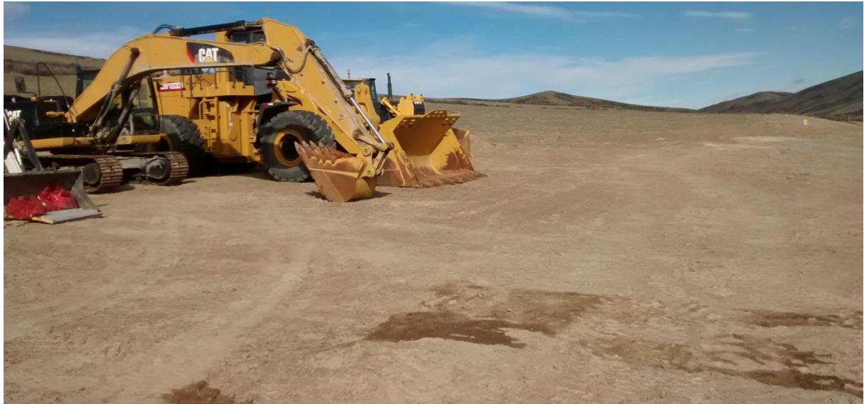
Figura 19. Área de estacionamiento de equipos, se observa lo que aparenta ser un derrame de hidrocarburo en suelo.
