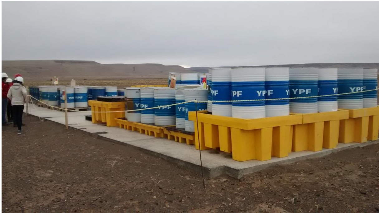
Figura 52. Acopio de aceites y lubricantes sobre contenciones secundarias insuficientes, y en parte sobre pallets en platea sin contención secundaria.
